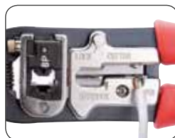
Зачистка круглого провода
